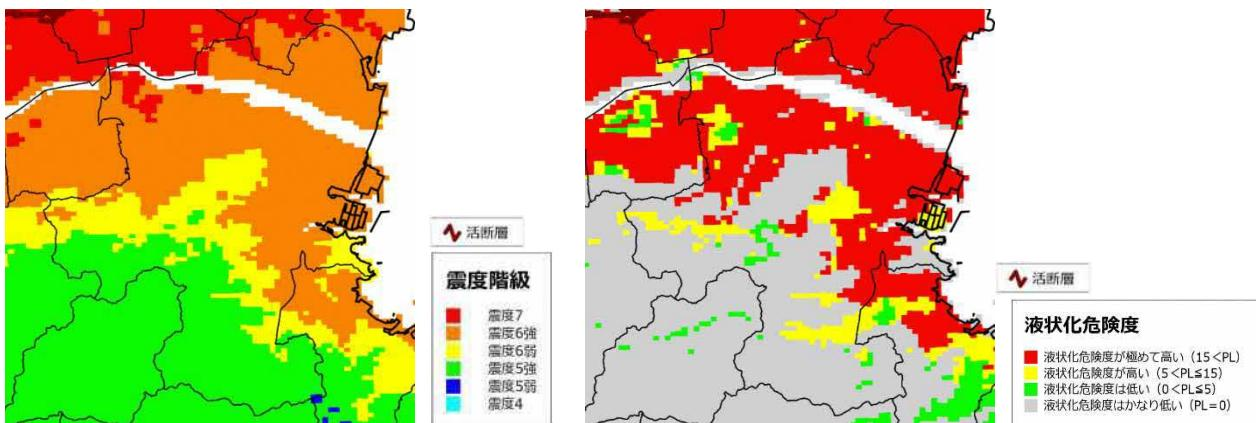
図 徳島県の想定する中央構造線・活断層地震による震度分布図（左）、液状化危険度分布図（右）
