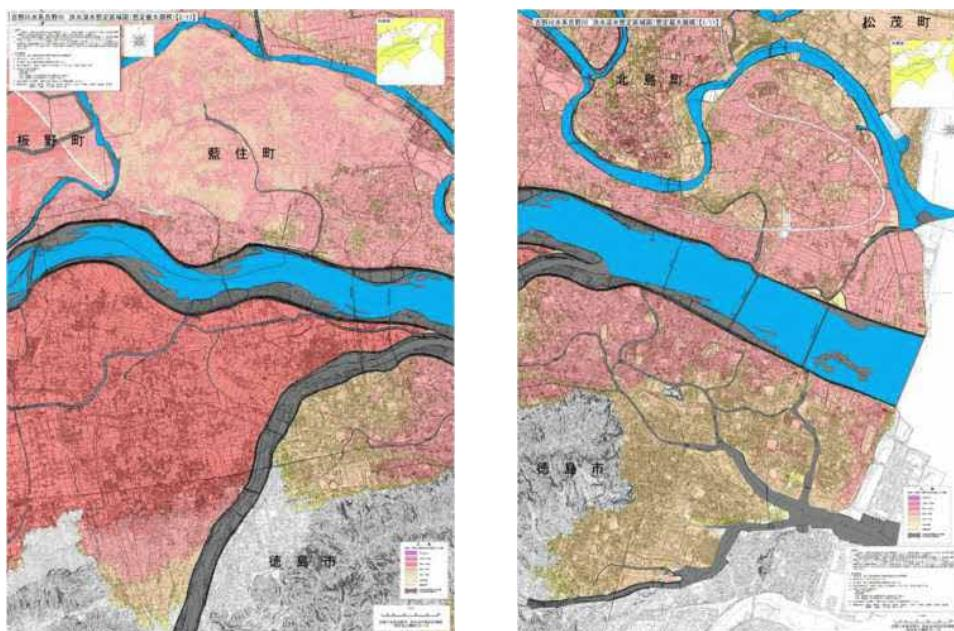
図 吉野川水系 吉野川 洪水浸水想定区域図（想定最大規模）
