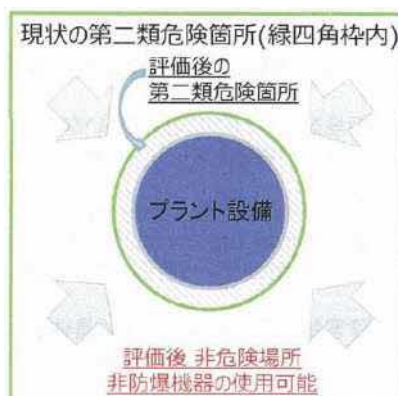
図 1. プラント内における非防爆機器の使用可能エリア拡大のイメージ
