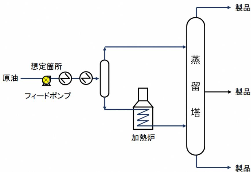
図 5.3 常圧蒸留装置フィードポンプ摺動部の危険区域のリスク評価
